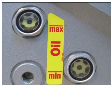
Rys. 8-2 Optymalny poziom oleju
