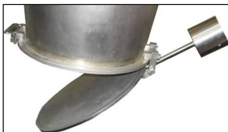
Rys. 0-25 Otwarta pokrywa spustowa zbiornika próżniowego
